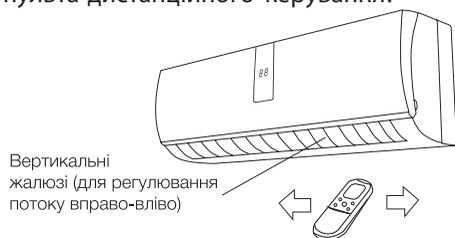
Напрямок повітряного потоку в горизонтальній площині змінюється самостійно користувачем поворотом вертикальних жалюзі.
